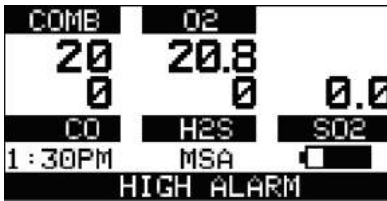
Bild 6 Alarmzustände (hier Hauptalarm)
